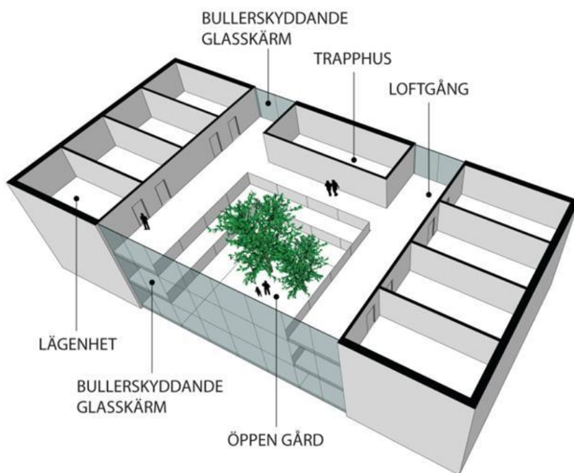
Figur 16. Princip för hur inglasade innergårdar skulle kunna utformas för att få till tysta sidor för lägenheterna i vissa av kvarteren. Källa: Bullerutredning, Akustikforum
